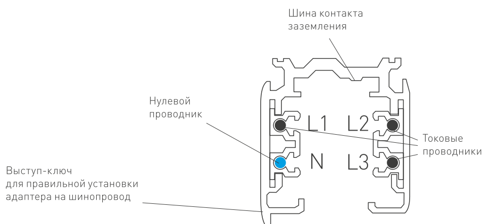
Рис. 1. Конструкция шинопровода
